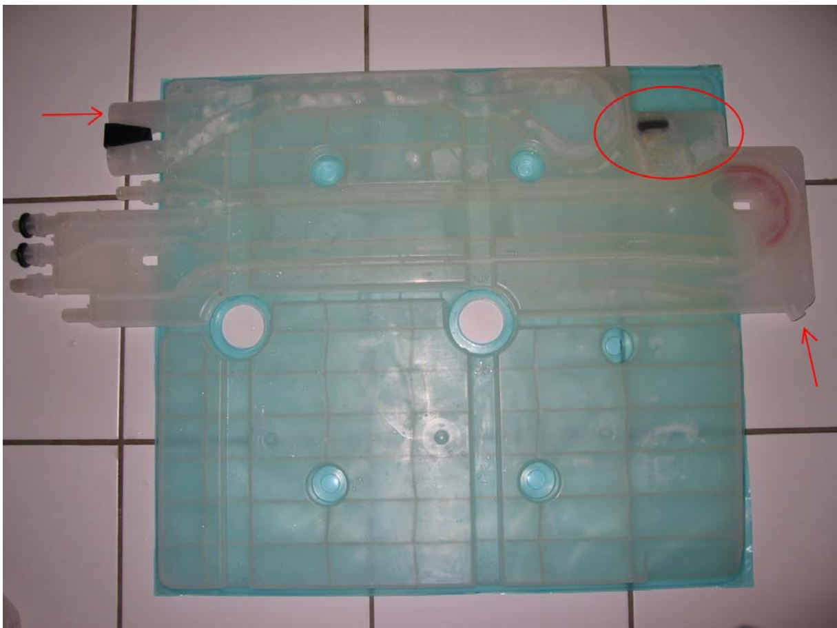
Abbildung 7 : Einlaufstelle für den chemischen Reiniger
