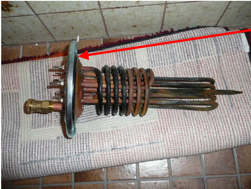
Bild 7: zeigt die Metallplatte in ausgebautem und gereinigtem Zustand mit den Heizstäben
