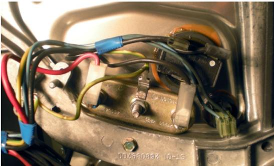
Den Motor abbauen. Dazu die beiden Muttern abschrauben und den Motor nach vorne abnehmen.
