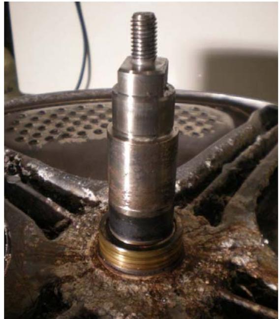
Sämtliche ausgebauten, erreichbaren Teile sollten gereinigt werden, das gilt besonders auch für Stellen an denen Dichtungen sitzen, z.B. zwischen Bottich und Rückwand.
