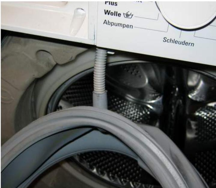
Je nach Ausführung haben einige Modelle auf der Oberseite der Türmanschette noch ein Schlauch für die Fensterspülung anschlossen. Bei der Ersatzteilebestellung sollte hier aufgepasst werden.
