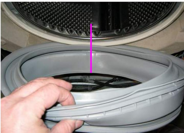
Bei der Montage der neuen Manschette darauf achten, dass die angedeutete Auslaufrinne unten in der Mitte ist.
