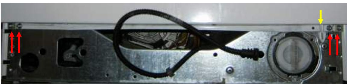
Darunter versteckt befinden sich die Schrauben (rote Pfeile) für die Befestigung der unteren Gehäusefront. Je nach Modell und Baujahr befinden sich hier entweder 2 oder 4 Schrauben (auch 20er Torx). → Alle müssen heraus gedreht werden! Die Front kann jetzt noch nicht abfallen – keine Sorge! Bei späterer Montage muss darauf geachtet werden, dass die Notentriegelung (gelber) durch die vorgesehene Öffnung der Sockelleiste gesteckt wird.
