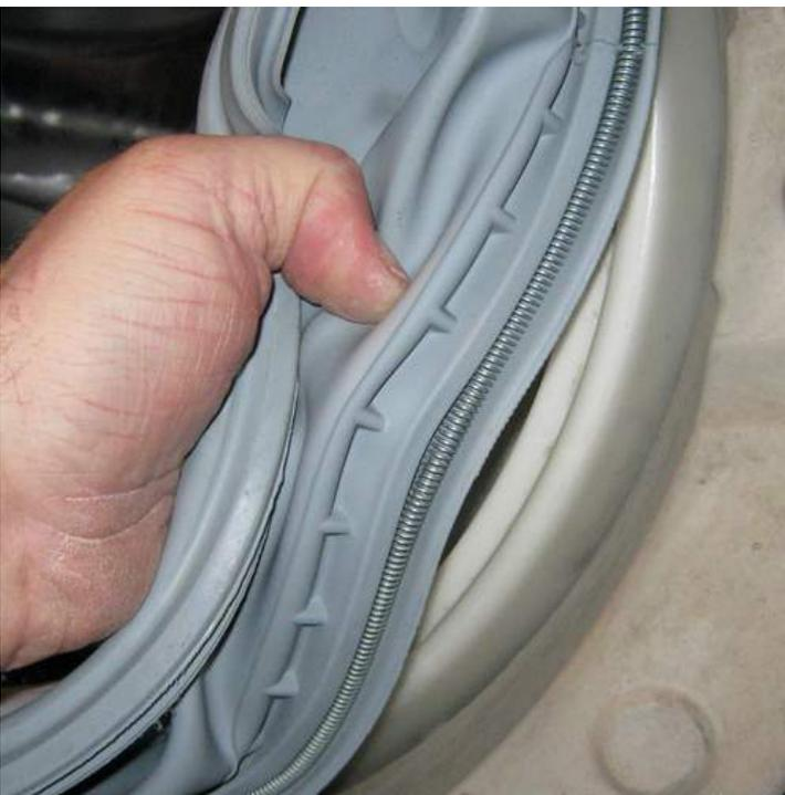
Für die hintere Demontage der Maschine muss etwas Kraft angewendet werden. In die Manschette eingreifen und ganz hinten am Spannring nach aussen drücken und gleichzeitig abziehen.
