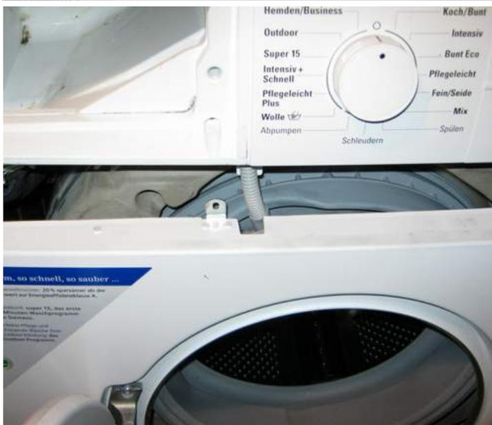
Die Front an der Unterseite zuerst vom Gerät abziehen und die Front dann nach unten abnehmen und am Boden ablegen.
