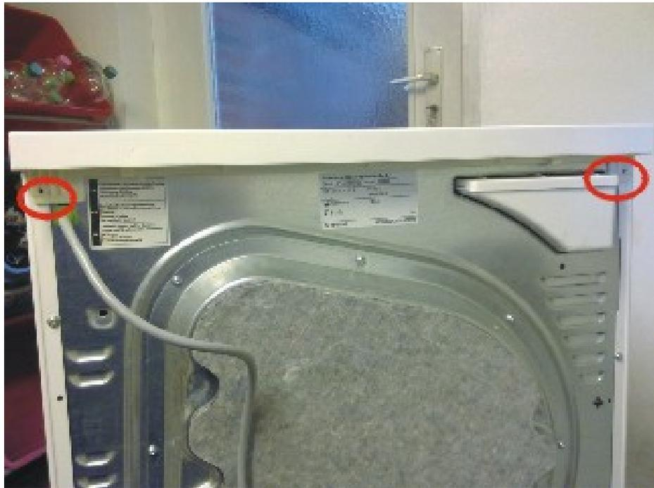
[DE] Bedienblende entfernen – Befestigungsschrauben lösen
