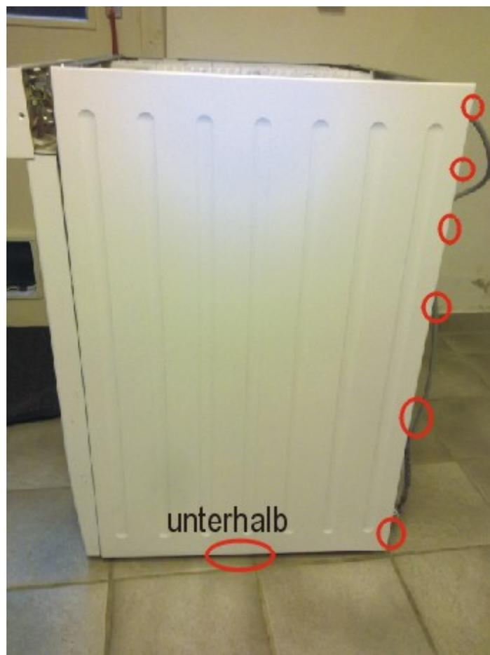
[DE] Kondensatpumpe entfernen – Befestigungsschrauben lösen.
