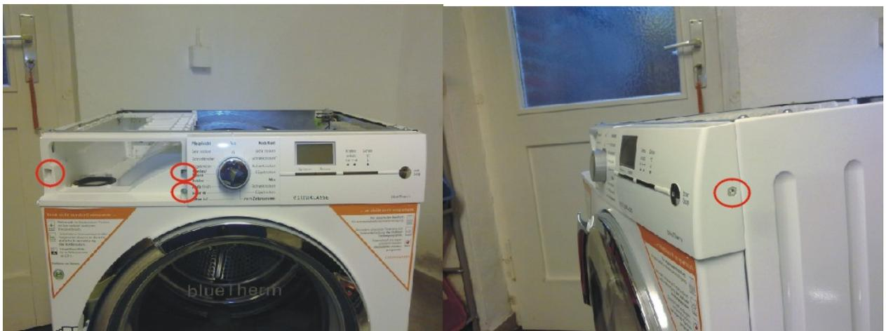
[DE] Seitenwand entfernen – an den gekennzeichneten Stellen Schrauben entfernen
