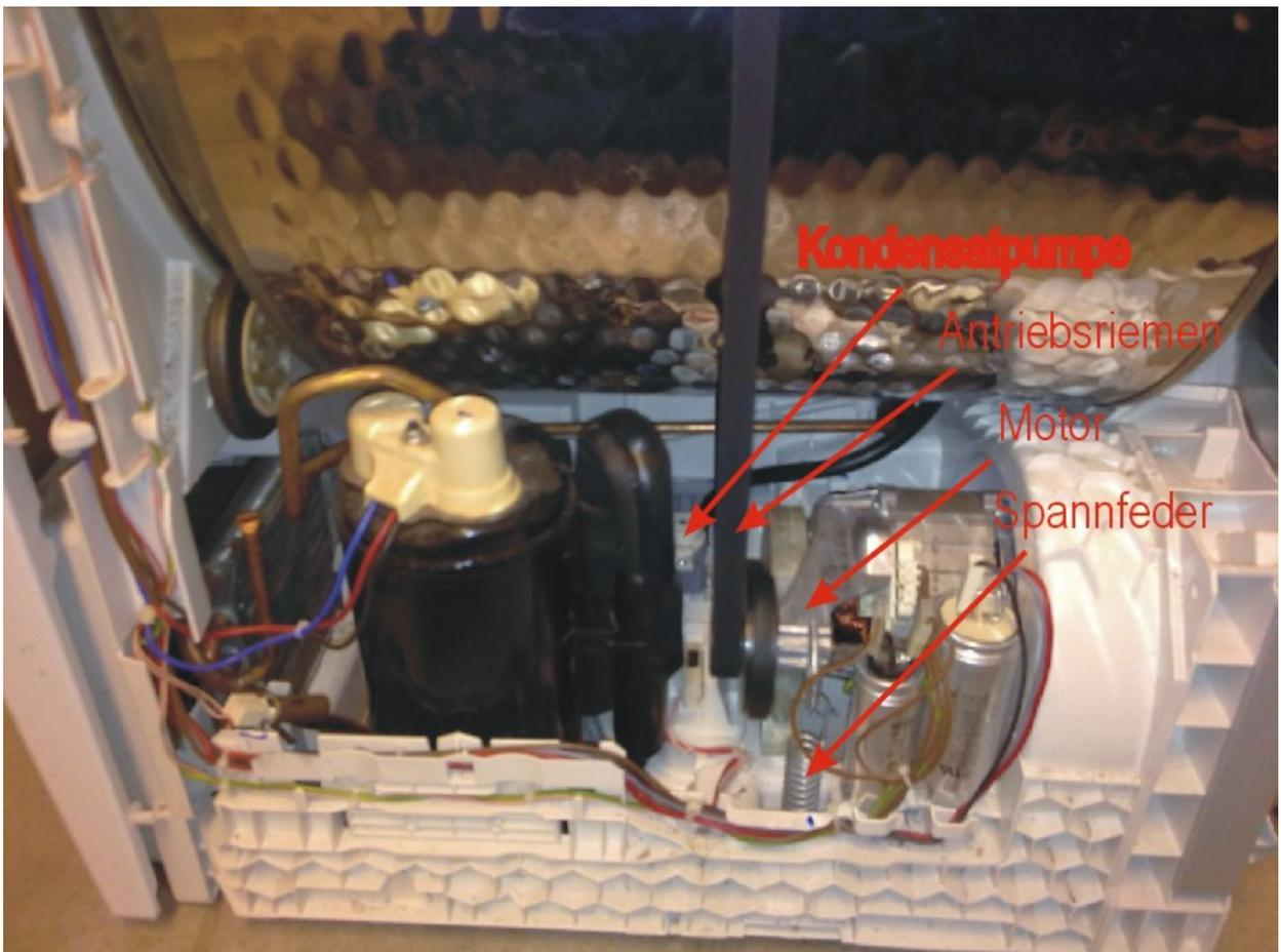
[DE] Kondensatpumpe ausbauen und Kanal reinigen. Wenn Ihr nun die Kondensatpumpe entfernt habt, werdet ihr schon einiges an Flusen sehen. Nun mit einer Gießkanne Wasser von oben in den Kondensatbehälter gießen, damit der Wärmetauscher frei gespült wird. Die Flusenrückstände werden am besten mit einem Nasssauger aus der Kammer der Kondensatpumpe entfernt. Diesen Vorgang solange wiederholen bis keine Flusen mehr rausgespült werden
