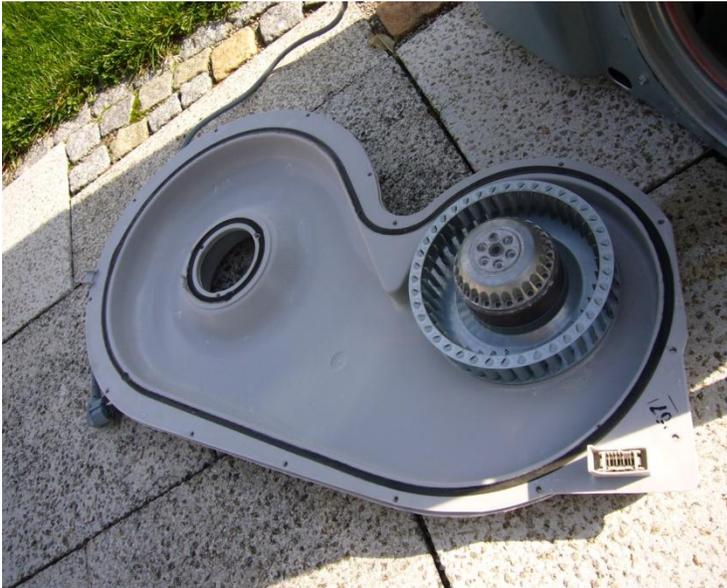
So sollte das aussehen (hier Dichtung am Kunststoff, Dichtung kann auch am Gehäuse bleiben).
