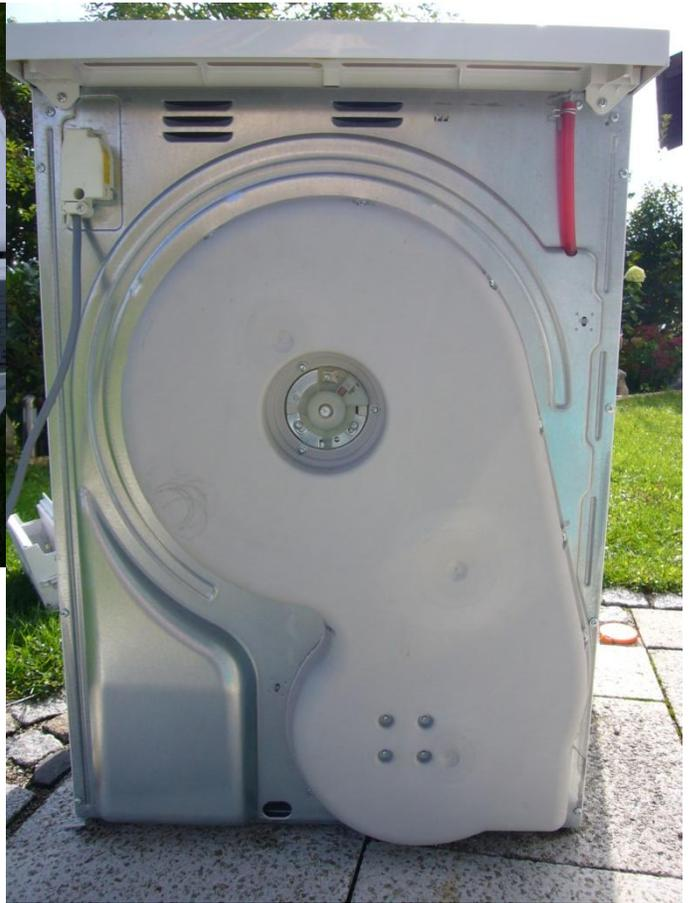
Dann die 15 Schrauben rund um das graue Kunststoffteil und die **3 Schrauben** an der sichtbaren Trommelachse entfernen (unterschiedliche Schraubenlängen).
