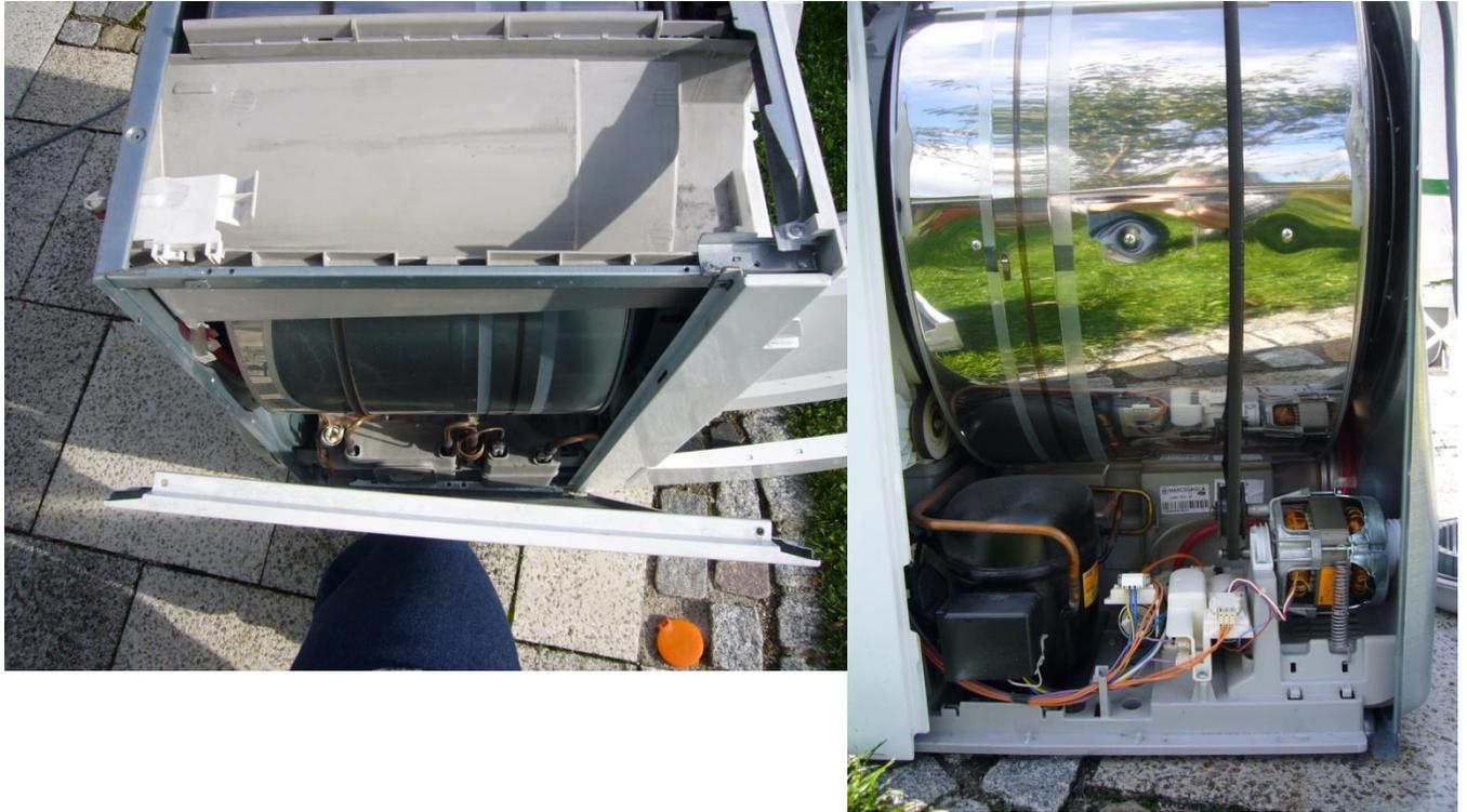
Anschließend unten den Stecker des Gebläses abziehen:
