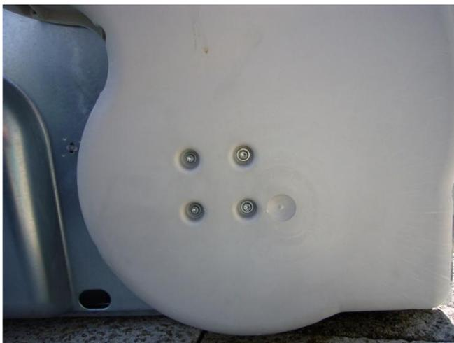
Nun die Seitenteile entfernen ((von vorne) links ist unbedingt erforderlich um einen Stecker zu lösen, rechts sollte ausgeblasen werden....). Dazu oben vorne eine Schraube und hinten vier Schrauben entfernen und das Blech nach oben/hinten ziehen (Dies Schrauben separat legen / anderes Format)
