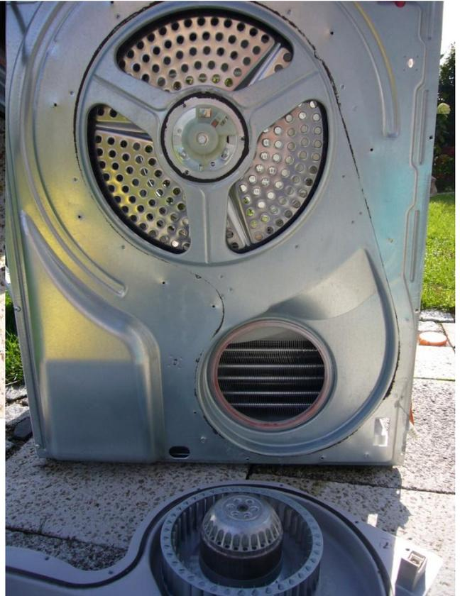
Die Klappe am Wärmetauscher lässt sich zur Sichtkontrolle nach unten wegziehen:
