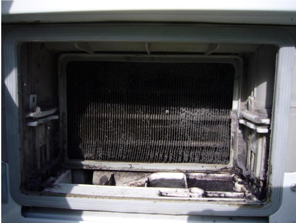
Letztes Jahr war die Kühleinheit fast komplett zu (da hatte noch den original Bodenfilter (schwammartig), diesen habe ich dann durch einen Feinfilter ersetzt - der hält weitaus mehr Feinstaub ab). Hier Bestellnummer falls er fehlt:
