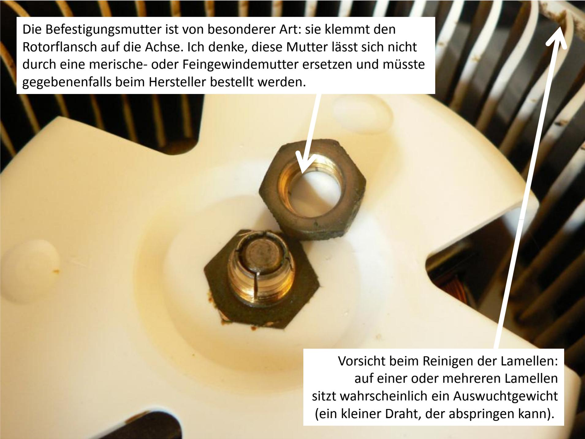
Die Befestigungsmutter ist von besonderer Art: sie klemmt den Rotorflansch auf die Achse. Ich denke, diese Mutter lässt sich nicht durch eine merische- oder Feingewindemutter ersetzen und müsste gegebenenfalls beim Hersteller bestellt werden.
