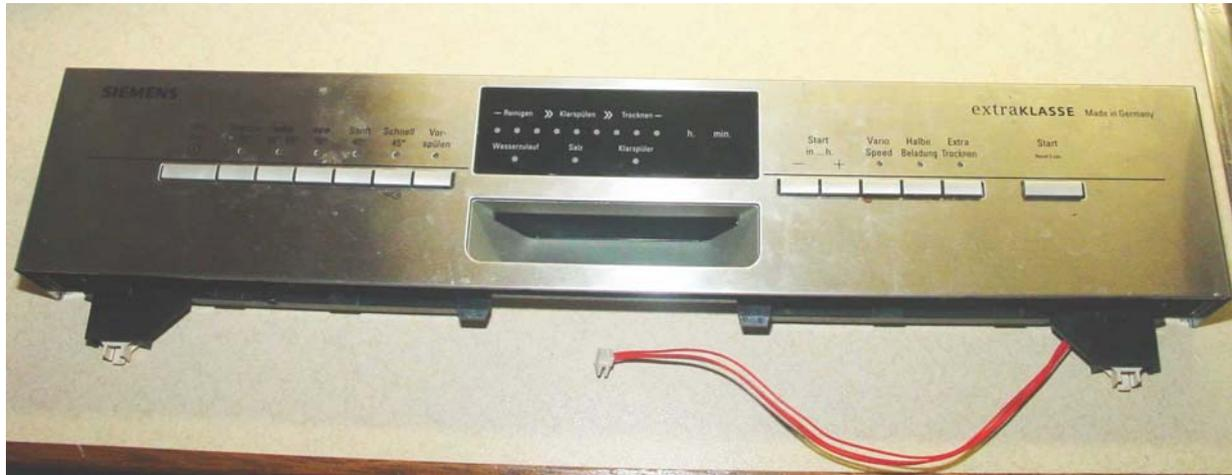
Zur Kontrolle der Maschinenfunktionen kann man über das Bedienfeld in eine Serviceebene gelangen. Man hält die Tasten 6 und 7 (von links gesehen) gleichzeitig gedrückt und betätigt den Hauptschalter ganz links. Im Display erscheint: P0
