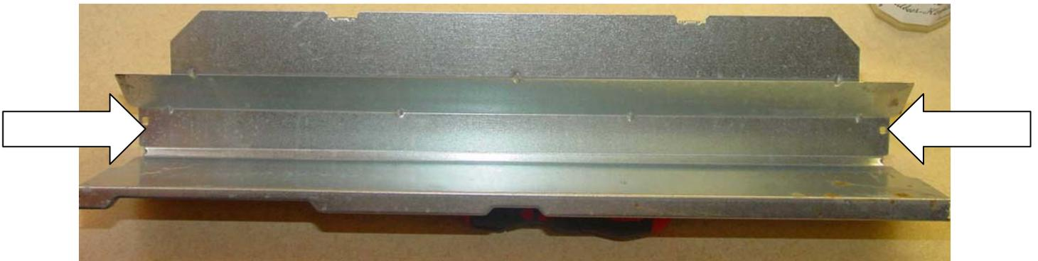
Nun die beiden Torx Schrauben links und rechts entfernen und das Abdeckblech abnehmen. Es kommt eine kleine Dämmmatte zum Vorschein die ebenfalls zu entfernen ist. Nächstes Bild:
