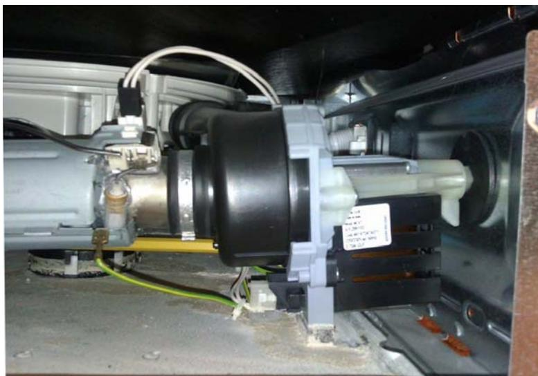
**Bild 7:** Alte Umwälzpumpe im Einbauzustand, von der rechten Geräteseite gesehen (hier noch mit Bodenblech)
