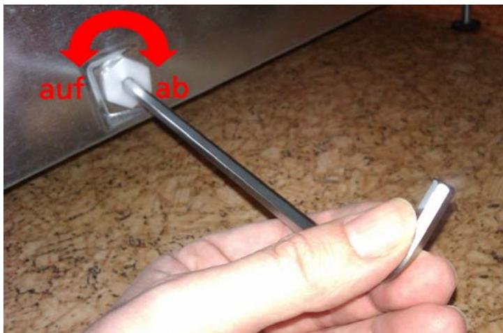
**Bild 1:** Heben (auf) und Senken (ab) der Maschine hinten
