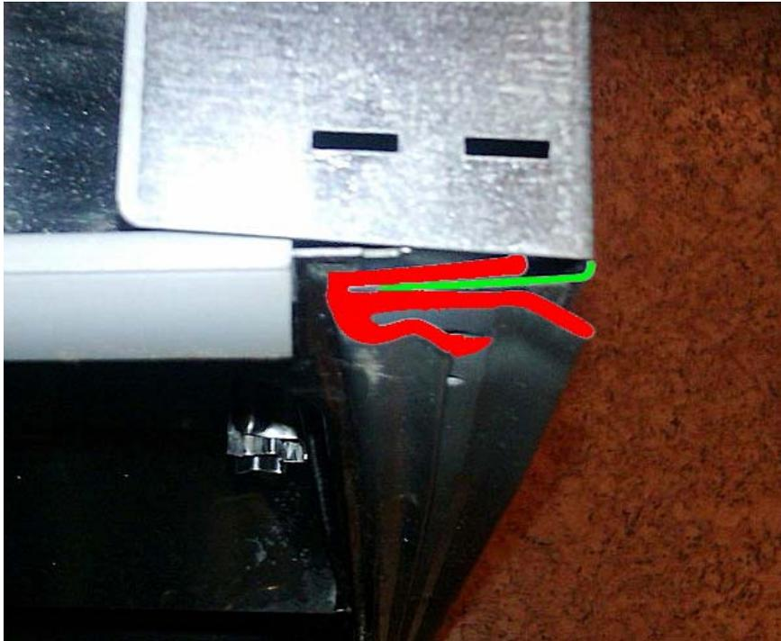
**Bild 6:** Gummilippe und Blechfalz am rechten Seitenblech (Blick von vorne oben rechts auf das noch aufrecht stehende Gerät)
