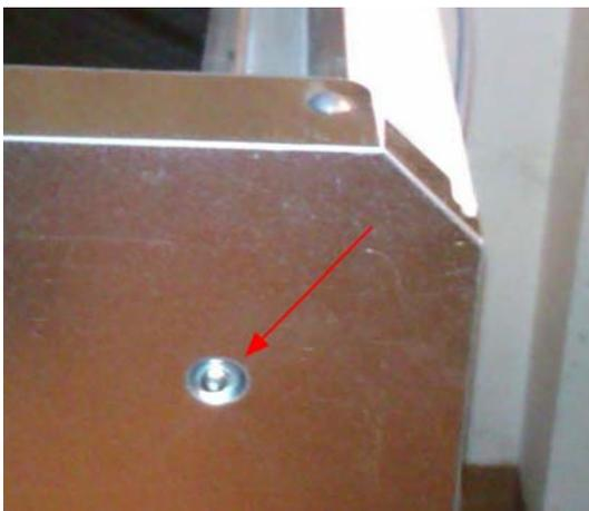
**Bild 4:** Position der seitlichen Schraube am rechten Seitenblech des noch stehenden Geräts
