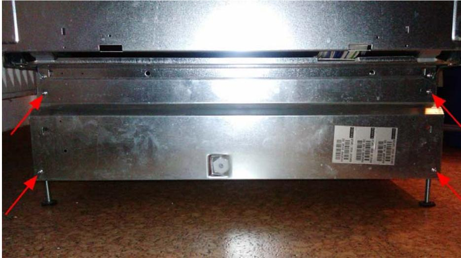
**Bild 3:** Positionen der vier Halteschrauben (Pfeile) für das untere Frontblech
