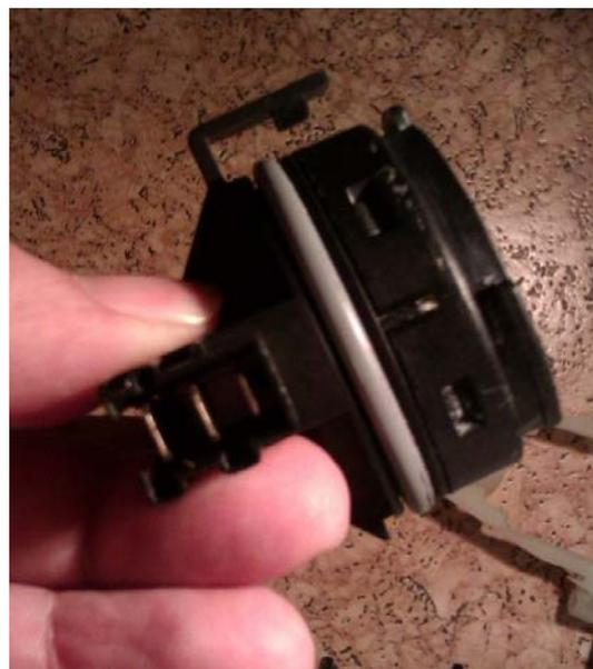
**Bild 14b:** Membranschalter, Seitenansicht mit dem elektrischen Anschluss
