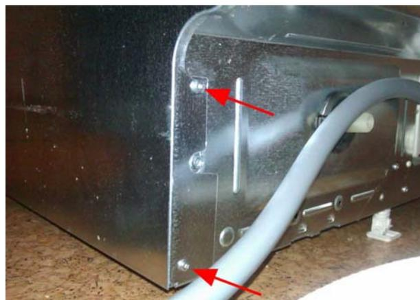
**Bild 5:** Positionen der rückseitigen Schrauben, die das Seitenblech halten (Geräterückseite)
