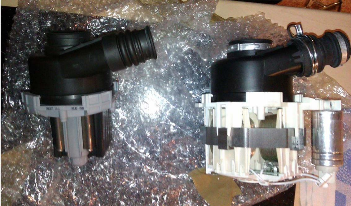
**Bild 9:** Vergleich der Bauformen „Magnetpumpe“, (links) und „konventionelle“ Pumpe (rechts). Das zusätzliche Kunststoffgestell mit der Spitze an der alten Pumpe ist abmontiert.
