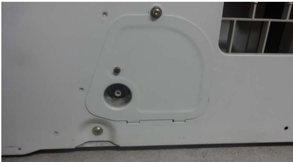
Wurde nun die Abdeckung abmontiert drehen wir das Reduzierstück raus. Bei älteren Modellen gab es diese Abdeckung auf der Geräterückseite noch nicht! Bei solchen Geräten muss zum Reinigen der Kondensatpumpe die Trommel ausgebaut werden. Es ist sinnvoll dann einen Kundendienst zu beauftragen.
