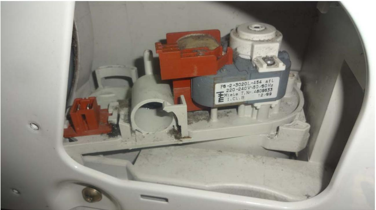
Mit einem Nass-Trocken-Sauger aus dem Baumarkt und einer Bürste oder, wie in meinem Fall einer Fugendüse mit Flexschlauch, beginnen wir damit dem Sumpf zu Reinigen.
