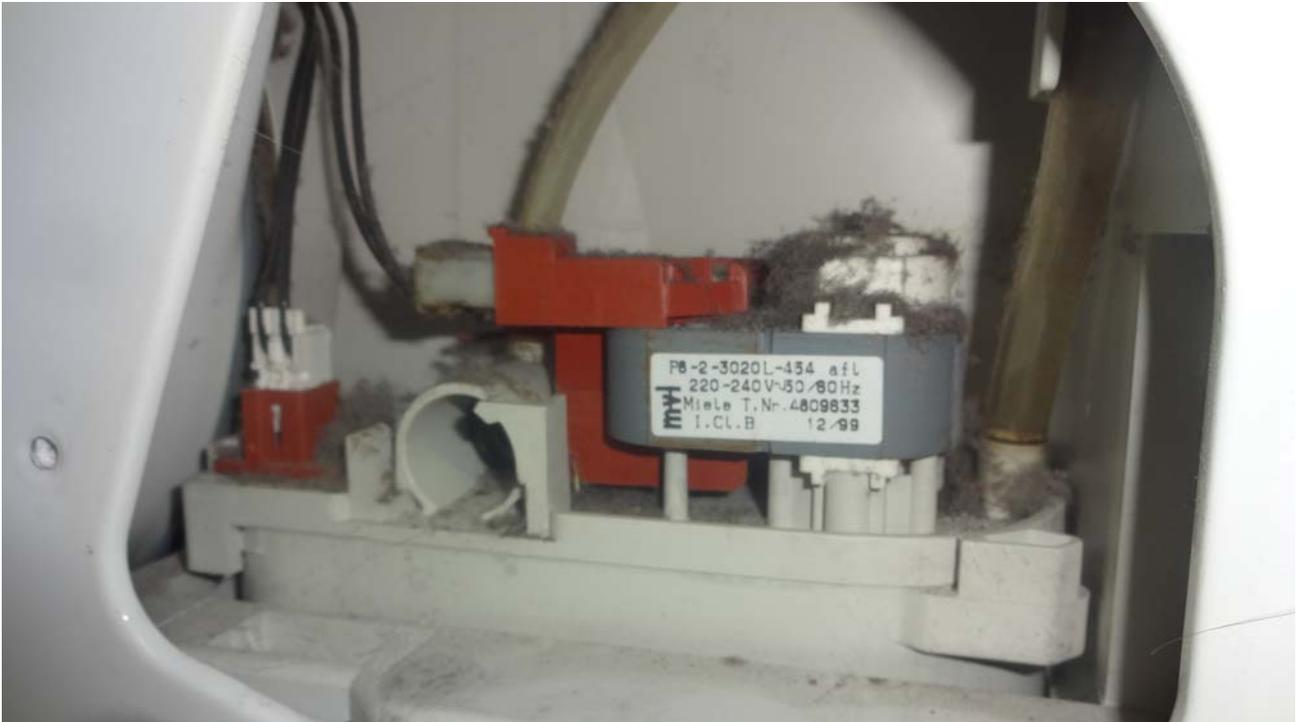
Nun beginnen wir damit die Arretierung der Pumpe zu Lösen, dafür die Arretiernase hinten Links bei dem „Bügel“ herunterdrücken und die Pumpe dabei etwas nach vorne Ziehen – Dann die Pumpe rechts etwas anheben und aus dem Gehäuse herausziehen.
