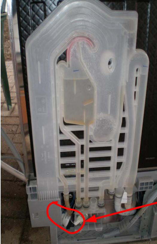
Der Flügelradzähler, der im Wasserzulauf eingebaut ist, hat keine Impulse geliefert. Neuen Zähler eingebaut, Maschine läuft.
