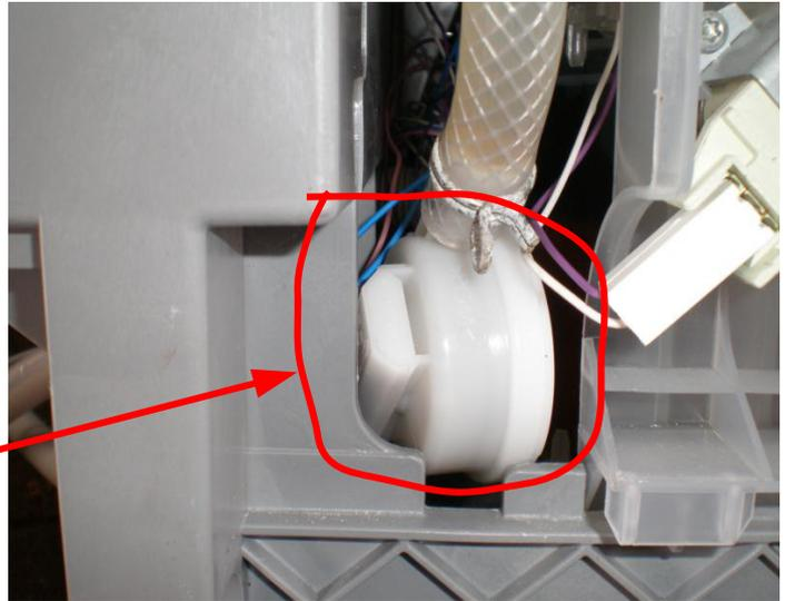
Ausgebauter Flügelradzähler (Der neue Zähler (klick!) wird ohne Schlauch geliefert)
