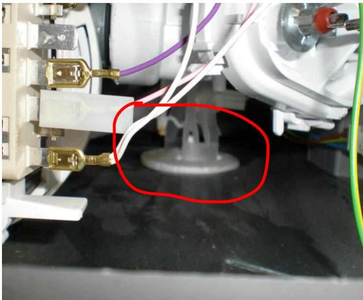
Um eine Leckage auszuschließen ist der Maschinenboden kontrolliert worden.
