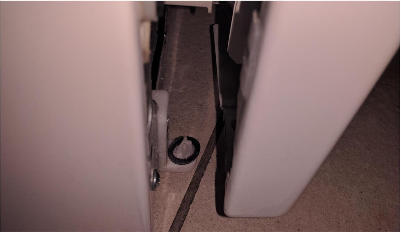
Die vordere Front ist an kleinen Füßen eingehakt, leicht anheben um sie zu lösen. Darauf achten dass das Dämpfer-Gummi auf den Füßen verbleibt. Die Front ist immer noch über die Gummimanschette mit der Maschine verbunden. Die Front weiterhin festhalten.
