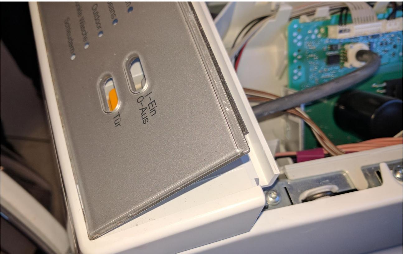
Die Blende der Bedienleiste von hinten etwas anheben und entfernen.
