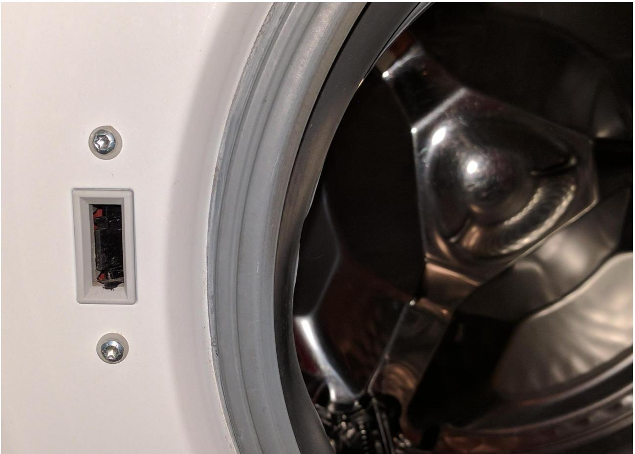
Die beiden Tx20 Schrauben des Türschlosses entfernen.
