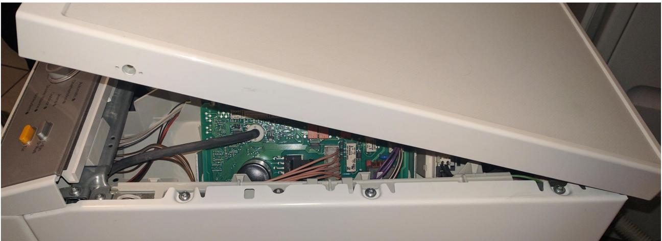
Der Deckel kann jetzt vorne angehoben werden und dann leicht nach hinten schieben. Am hinteren Ende ist er nur leicht eingehakt.
