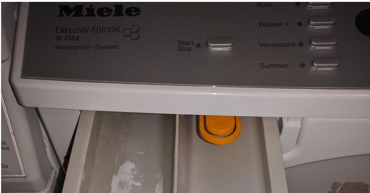
Die Waschmittelschublade wird entfernt, den gelben Hebel runter drücken um sie komplett zu entfernen.
