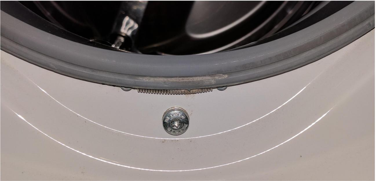
Entferne die Tx30 Schraube unterhalb der Einfüllöffnung.
