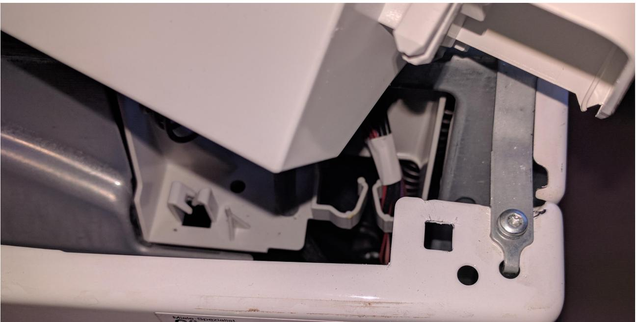
Die vordere Front ist noch mit zwei Tx20 Schrauben rechts und links befestigt, diese lösen und dabei die Front festhalten damit sie nicht versehentlich herunter fällt und beschädigt wird. An der rechten Schraube hat die Front noch einen kleinen Halt durch den Metallbügel.
