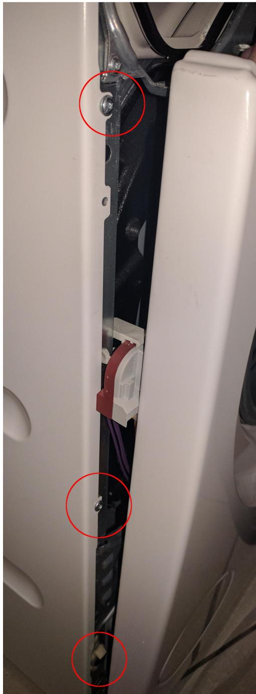
Die vordere Front jetzt etwas bewegen so dass man die 3 Tx20 Schrauben an der linken Front lösen kann. Danach die vordere Front wieder einsetzen und mit den beiden oberen Schrauben fixieren. Die linke Front kann jetzt entfernt werden. Achtung beim späteren Einbau der linken Front, sie wird am unteren Ende etwas einhakt.
